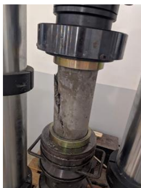
Figura 2. Realização do Ensaio de Compressão Axial com os corpos de prova.
