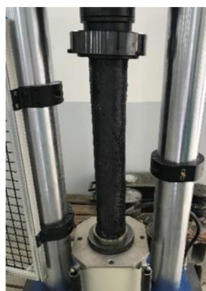
Figura 1. Realização do Ensaio de Compressão Axial com os pilares curtos, para avaliação da resistência
