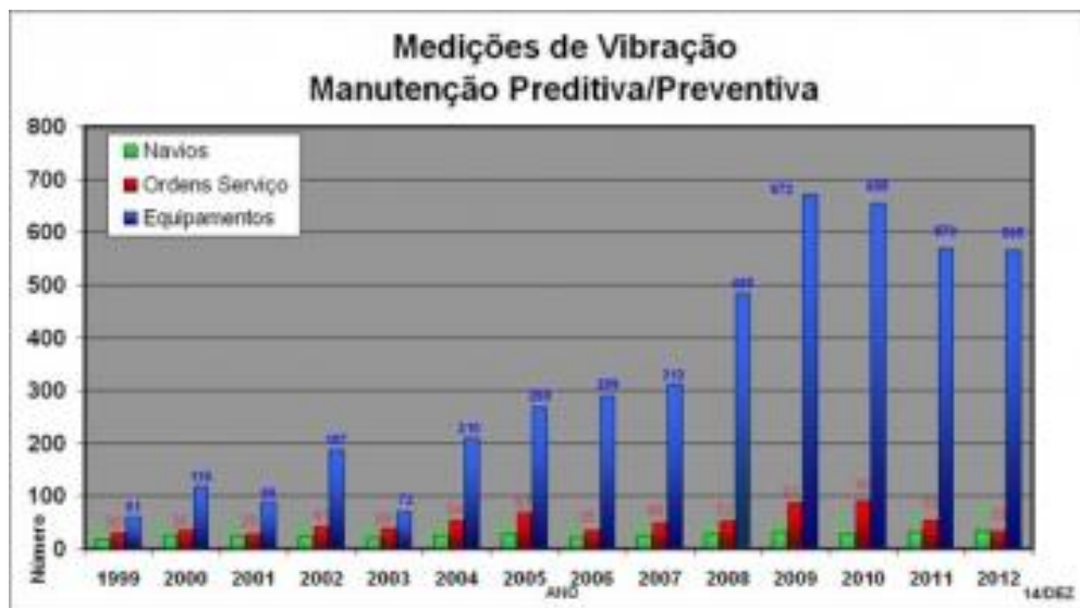
Figura 3: Trabalhos de manutenção preditiva (Fonte: CPN).
