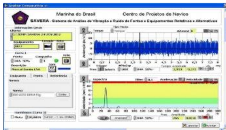
Figura 2: Medição de Vibração - Análise espectral (Fonte: CPN).
