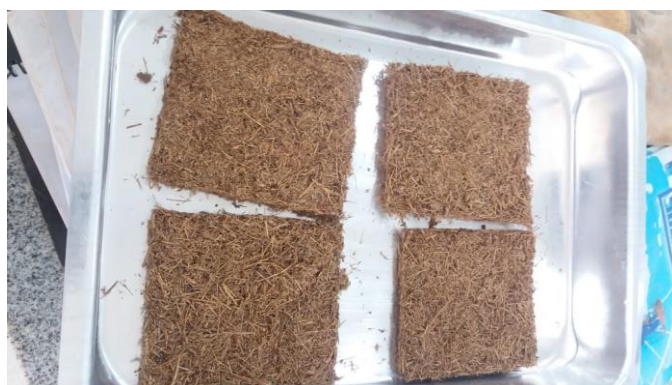
Figura 1 – Biomanta sem trançado
