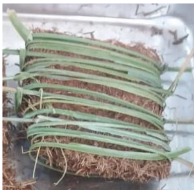
Figura 2 – Biomanta com trançado
