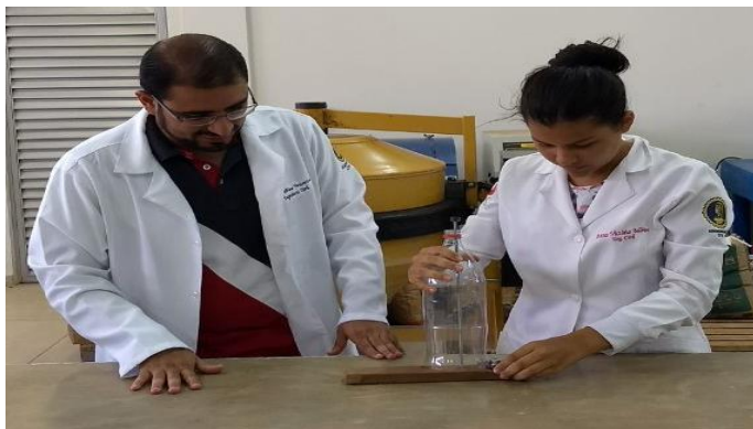
Figura 1 - Obtenção das fibras de PET com uso do filatador manual Fonte: Autor (2018)
